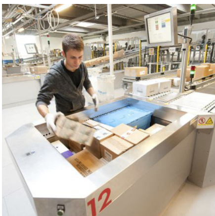
Système de palettisation hétérogène automatisée avec bras pousseur (Witron)
