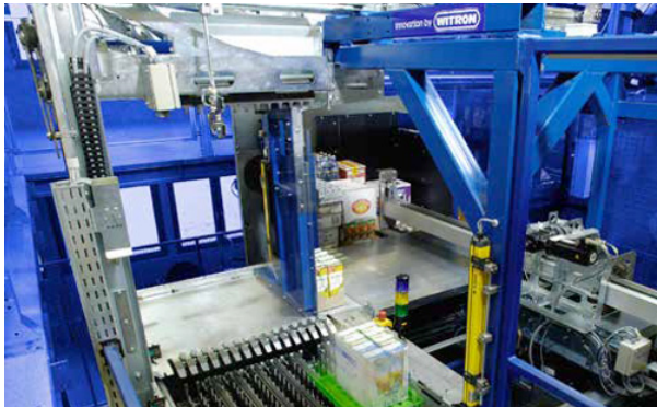
Système de palettisation hétérogène automatisée avec bras pousseur (Witron)
