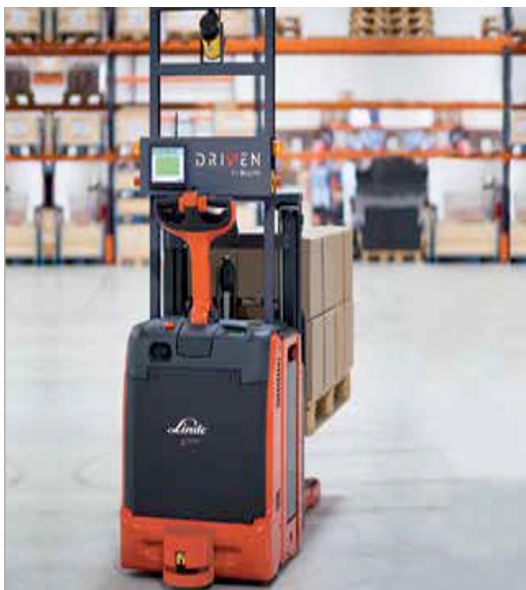
Chariot élévateur équipé d'un boîtier Baylo le rendant autonome
