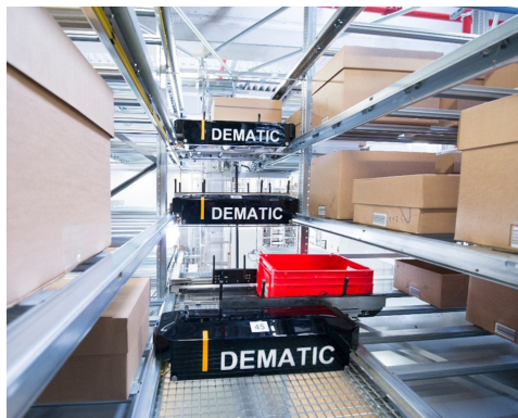
Multishuttle® Technologie à navettes (Dematic)
