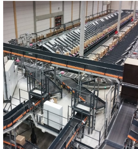
Système de tri pour Chaussée (Witron)
