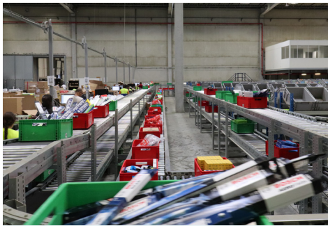
Système de convoyage Plug-and-Carry® Caroussel de réception (Boa Concept)
