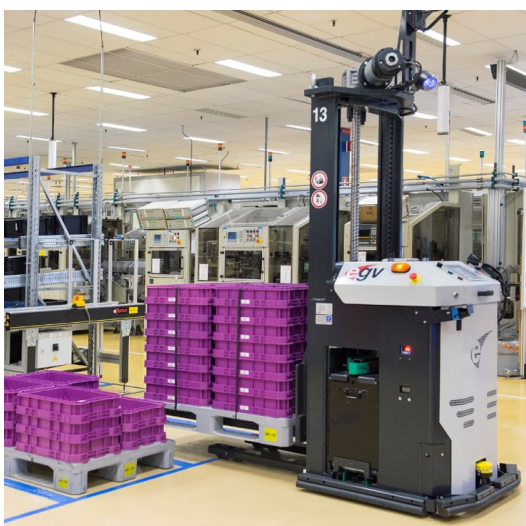
Chariot élévateur équipé d'un boîtier Baylo le rendant autonome
