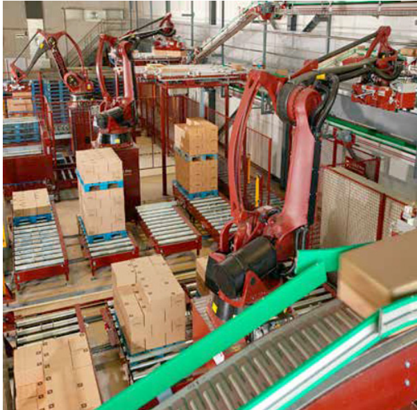
Bras robotisés lors d'opérations de palettisation en bout de ligne de production (Witron)
