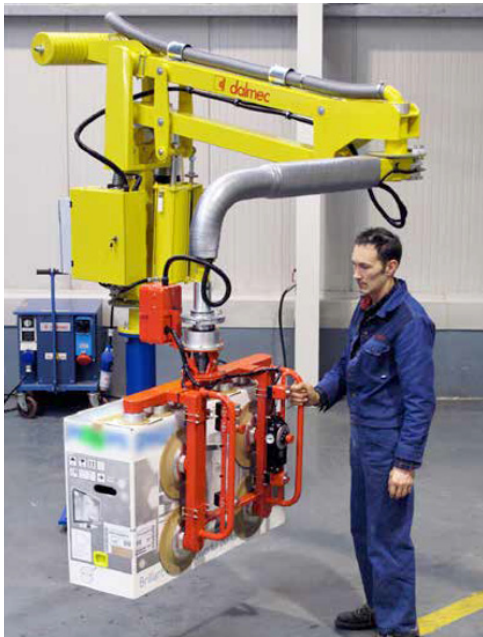
Utilisation de cobot Dalmec pour l'aide à la palettisation
